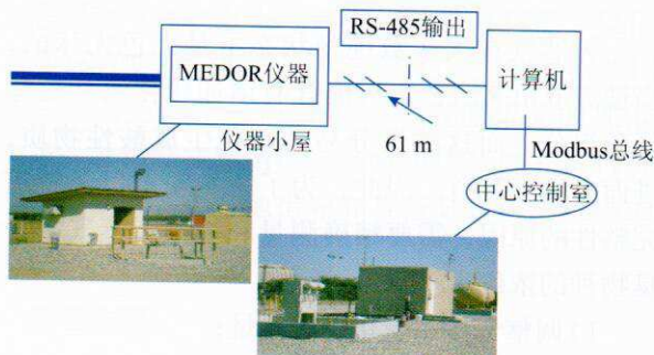
图2 MEDOR Exp 防爆型分析仪的安全设置
