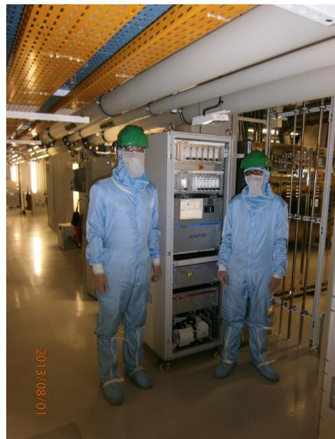
phiques complexes utilisant des produits chimiques très réactifs. La nature et la concentration des composés volatils peuvent être différentes selon le procédé chimique et peuvent aussi varier rapidement. Il est donc nécessaire de pouvoir analyser précisément et en continu les gaz dans l'air ambiant avec un instrument destiné à un usage industriel.
