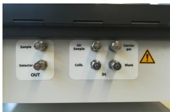
Figure 5 : Bouchons entrées/sorties gaz à retirer avant utilisation
