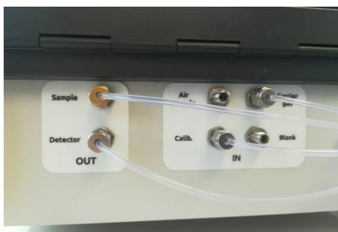
Figure 8 : Exemple de connexion des sorties de l'analyseur microBTEX
