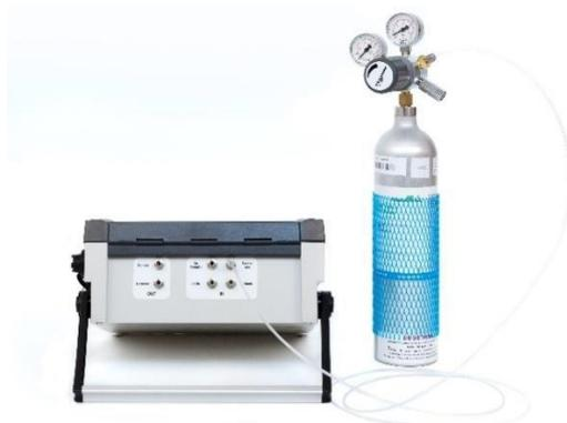
Figure 6 : Mise en place de la tubulure pour le gaz vecteur
