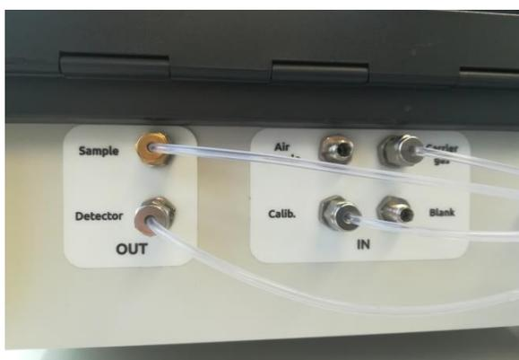
Figure 7 : Exemple de mise en place d'une tubulure gaz au niveau de l'entrée Calib.
