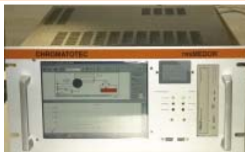
Nouvel analyseur pour la détection des composés soufrés volatiles TRS (Total Reduced Sulfur) dans l'air ambiant, TRSMEDOR
